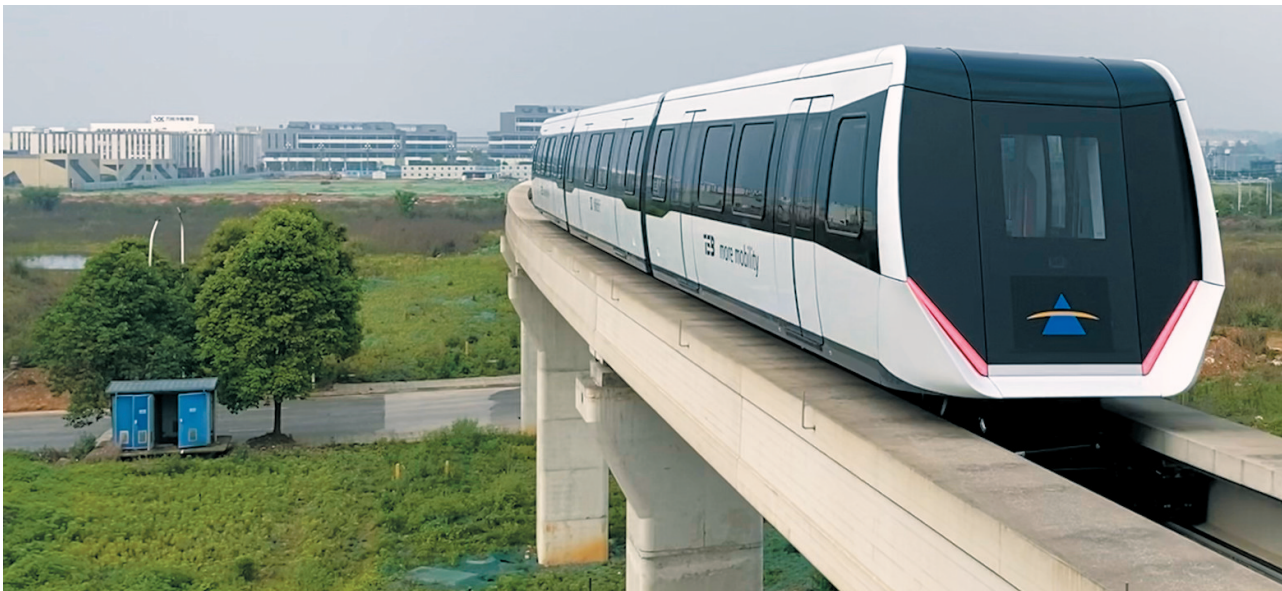
内嵌式磁浮交通系统在成都新津建设了3.6公里中低速模拟商业运营试验线。
