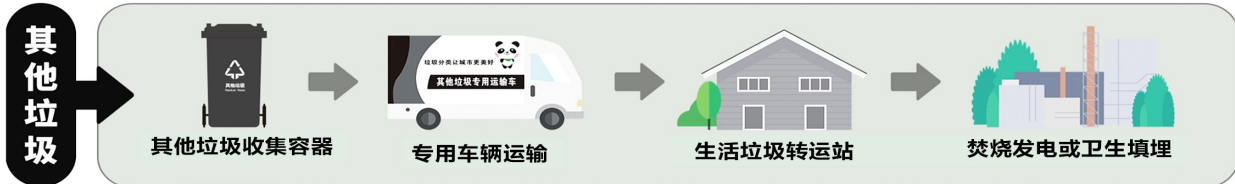
生活垃圾分类收运处理流程示意图。制图 杨仕成
