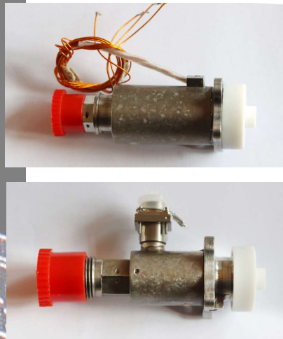
▲两种电磁阀都用在“天问一号”环绕器的发动机上,起到开关和控制的作用,一个控制氧化剂路,一个控制燃料路。
