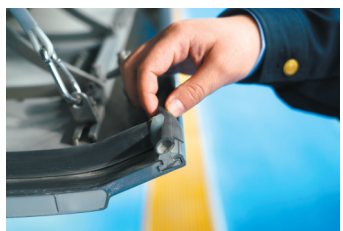
新型高寒动车组水箱密封胶条,胶条采用硅橡胶材质,更适应低温环境。 新华社发
