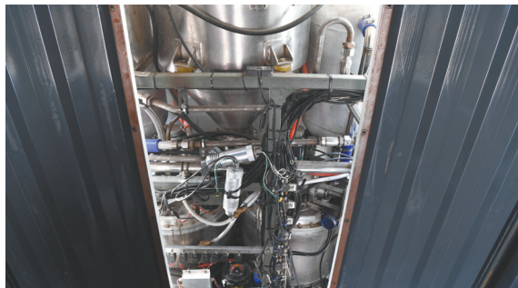
车上的“车载水解制氢”系统。新华社发
