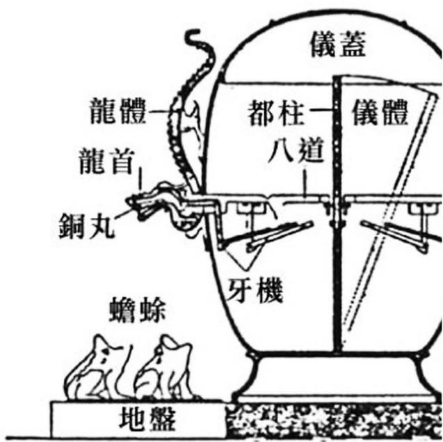
王振铎所复原的地动仪模型原理。
