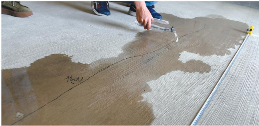
新交的房屋出现裂缝,楼上业主现场浇水检验地板渗水情况。
