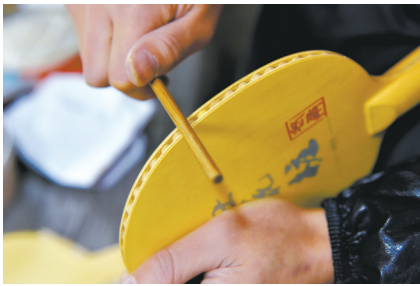
乒乓球拍制作一个很重要的工序就是打磨，光是砂纸从粗到细就有5种，最后还需要用筷子来打磨光滑。
